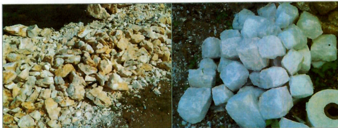
Foto 2 – Feldspato antes e depois do tratamento manual (Data: 19/07/2013)
