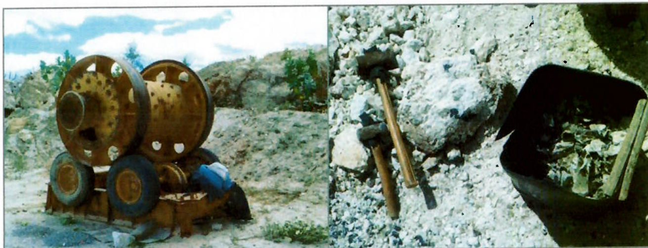
Foto 1 – Acionamento improvisado e ferramentas feitas pelos trabalhadores (Data: 19/07/2013)
